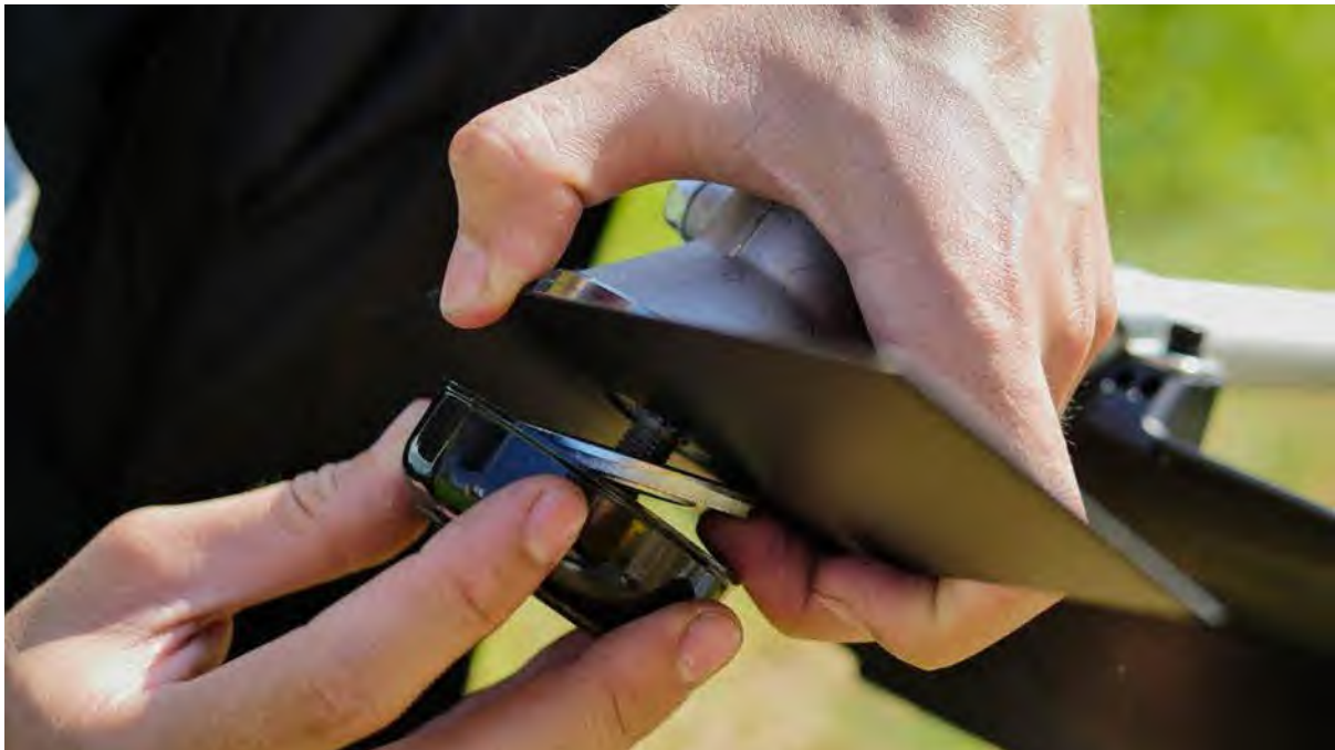
ตรวจสอบการความแน่นของใบมีดก่อนใช้งานทุกครั้ง
